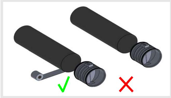
Los reguladores del tipo VOLKOM únicamente deben montarse utilizando una junta de obturación adecuada. ¡Queda prohibido cualquier otro tipo de montaje, por ej. mediante tornillos!
