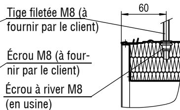
Préparée pour la suspension au moyen d'une tige filetée et d'un écrou M8, à fournir par le client (uniquement avec -BB).
