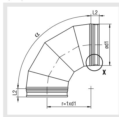
Des coudes avec d'autres angles de courbure ( $\alpha$ ) ne peuvent pas être utilisés.
