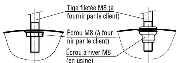
Préparée pour la suspension au moyen d'une tige filetée et d'un écrou M8, à fournir par le client (uniquement avec -BB).
