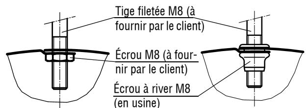
Préparée pour la suspension au moyen d'une tige filetée et d'un écrou M8, à fournir par le client (uniquement avec -BB).
