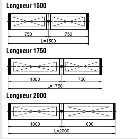
Les composants de diffuseur RR d'une longueur > 1000 mm sont fabriqués en 2 parties et reliés en usine au moyen d'un manchon de raccordement. Les dimensions du tube vide correspondent aux dimensions des composants de diffuseur RR DBBRR / KGRR / DSARR / WGARR.
