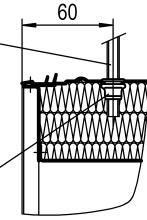
Préparée pour la suspension au moyen d'une tige filetée et d'un écrou M8, à fournir par le client (uniquement avec -BB).
