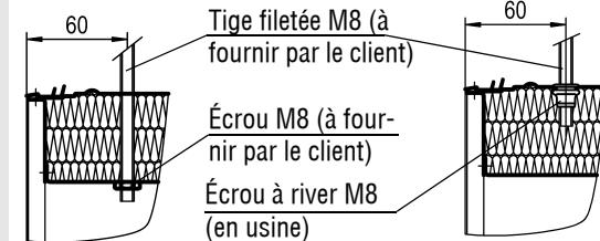
Préparée pour la suspension au moyen d'une tige filetée et d'un écrou M8, à fournir par le client (uniquement avec -BB).
