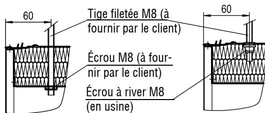
Préparée pour la suspension au moyen d'une tige filetée et d'un écrou M8, à fournir par le client (uniquement avec -BB).
