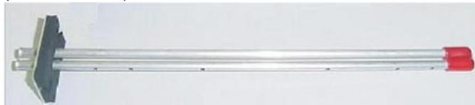
Les capteurs de pression différentielle (graduations de mesure) doivent être montés par le technicien de SCHAKO conformément à la notice de modification. Les croix de mesure, les graduations de mesure ou les diaphragmes existants peuvent également être réutilisés comme alternative.
