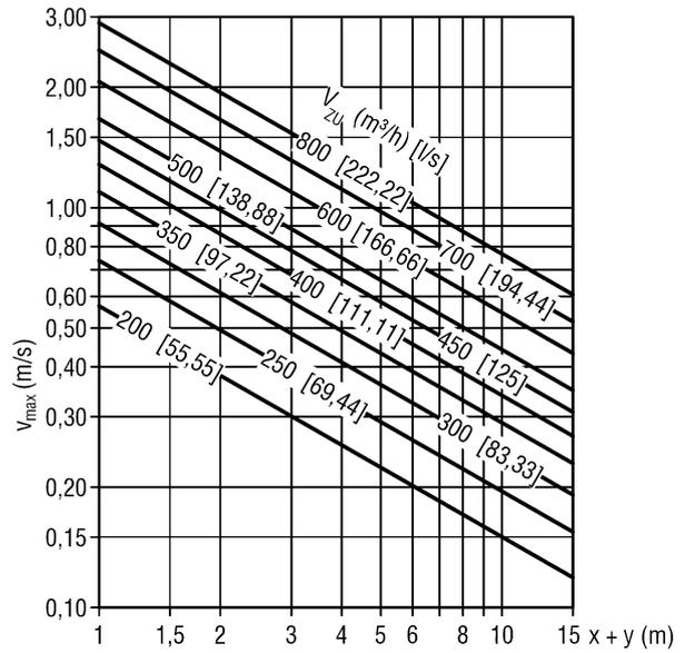
**Korrekturfaktor Luftführung divergierend, nach oben ausblasend**
