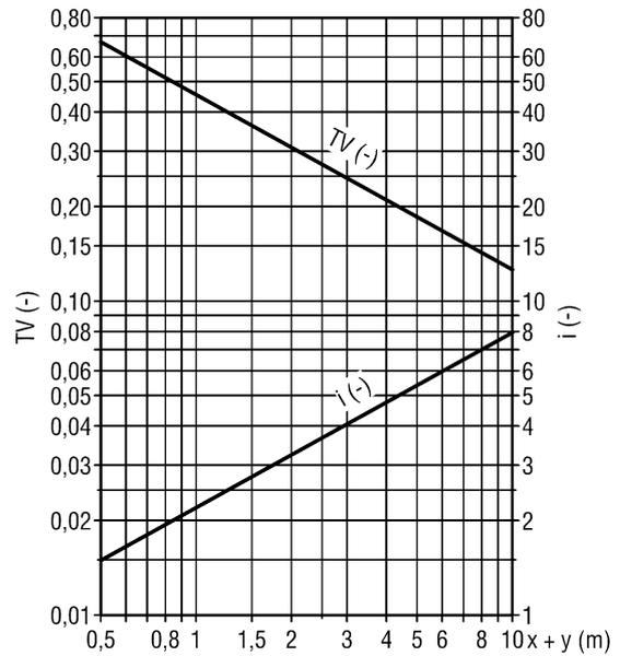
Korrekturfaktor Luftführung divergierend, nach oben ausblasend
