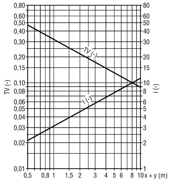
Korrekturfaktor Luftführung divergierend, nach oben ausblasend
