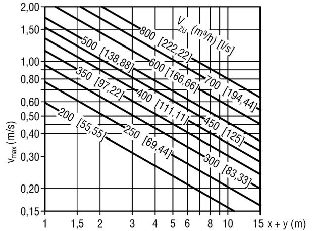
**Korrekturfaktor Luftführung divergierend, nach oben ausblasend**
