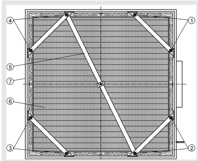
Allentare il tendifiltro (pos. 4) e rimuoverlo insieme al dispositivo di sicurezza per il trasporto. Spingere la cella del filtro assoluto (pos. 6) con la guarnizione in gomma verso l'alto all'interno dell'alloggiamento del filtro (pos. 7). Fare attenzione che il materiale del filtro non venga danneggiato.
