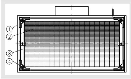
Allentare il tendifiltro (pos. 4) e rimuoverlo insieme al dispositivo di sicurezza per il trasporto. Spingere la cella portafiltro (pos. 2) con la guarnizione in gomma nell'involucro filtro (pos. 1) in direzione della parete posteriore. Fare attenzione che il materiale del filtro non venga danneggiato. Le traverse VM (pos. 3) vengono posizionate sull'involucro e fissate con i tendifiltro angolari (pos. 4).
