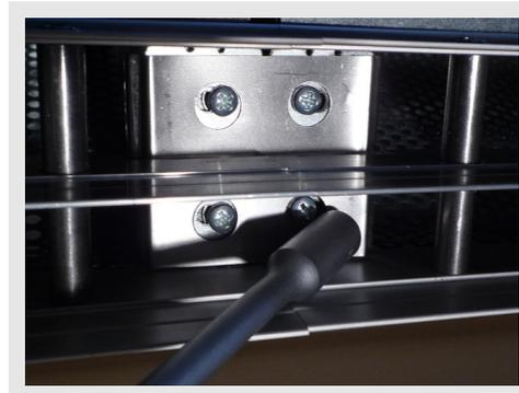
Insérer à nouveau les ailettes dans le sens de soufflage correct (fig. 7.1 - 7.2)
