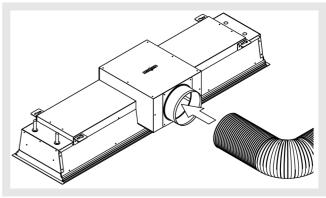
Opcionalmente, el equipo se puede suministrar con una junta labial de goma en las bocas de conexión que le permite una estanca conexión entre el equipo y el conducto.
