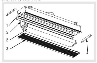
**Carcasa (1):** chapa de acero galvanizado con 1 o 2 bocas de conexión de diámetros 98, 123 (estándar) y 148 mm. La posición de las bocas puede ser por conexión vertical (-**V**, estándar) u horizontal (-**H**).
