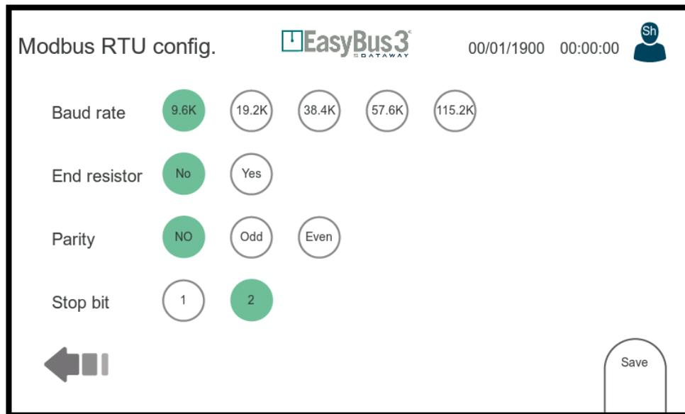
Cet écran permet la configuration du Modbus RTU/BACnet MSTP. Modbus RTU/BACnet MSTP est une interface série. Les paramètres sont les suivants (de haut en bas) :
